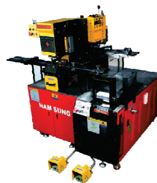
Máy gia công thanh cái
