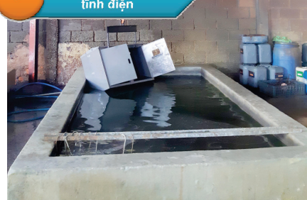
7 Xử lý trước khi sơn tĩnh điện
